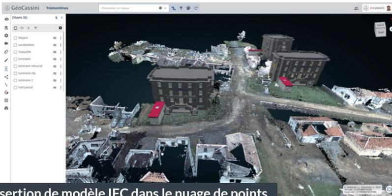
Insertion de modèle IFC dans le nuage de points
